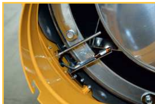
Senzorul de temperatura: permite functionarea indelungata fara probleme. Termostatul impiedica atingerea unor temperaturi ridicate
